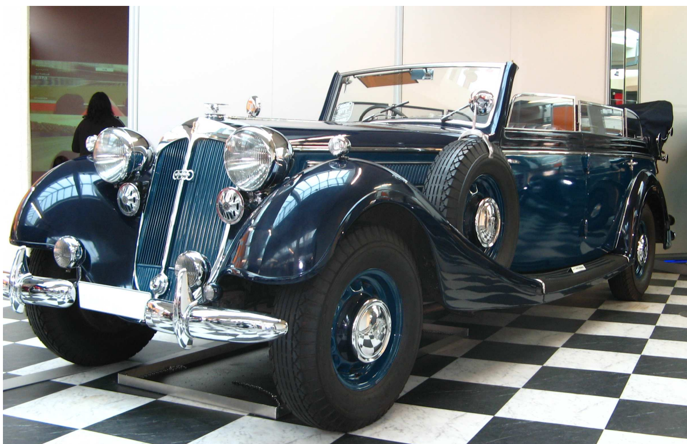
Horch-Pullmann-Limousine von 1937. 5L 8-Zylindermotor mit 120 PS, 130km/h, 520 Stück gebaut
